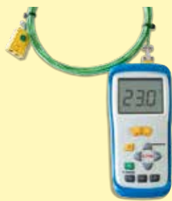
Měřič teploty pro RAKU pec 100
