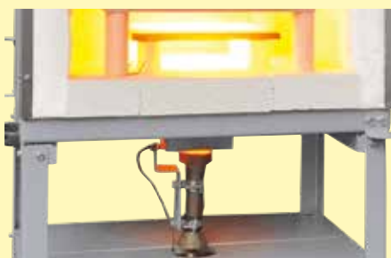
Propanový hořák s výkonem 15 kW namontovaný pod pecí
