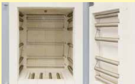
Vyhřívání z pěti stran a speciální uspořádání topných článků pro optimální rozložení teploty
